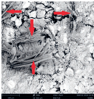
Foto č. 3 ze SEM (Scanning Elektron Microscopy / rastrovací elektronový mikroskop) - Povrch eternitové šablony při zvětšení 500x. Jasně viditelné svazky azbestových vláken na narušeném povrchu šablony.
